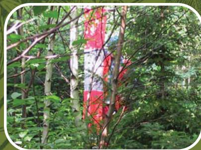
Plache à profil permettant la mesure de l'obstruction latérale
